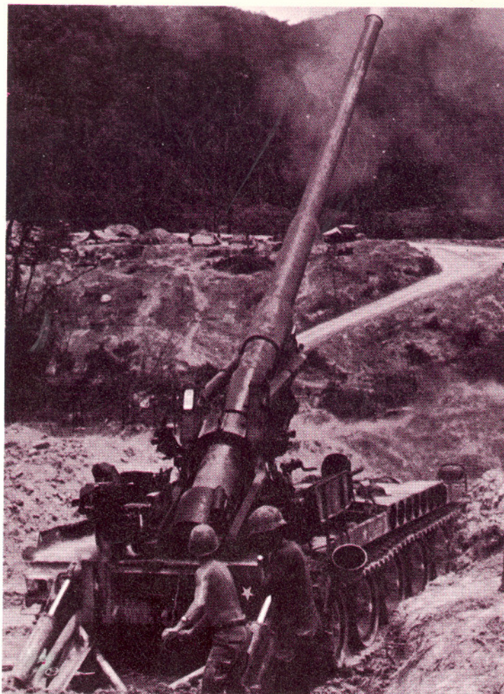
Fent: Az M107 175 mm-es löveg a vietnami háború idején támadásban, 151,5 fontos (68,78 kg) HE lövedékkel tüzel
