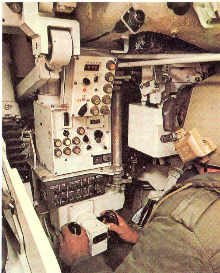
Fent: A Merkava Mark 1 toronyának belső látképe az irányzóállással a torony jobb oldalán. A periszkóp magába foglalja a mozgó tükörfejet és az elektrooptikai lézer típusú távmérőt, 8x-tól 1x-ig terjedő nagyítással
