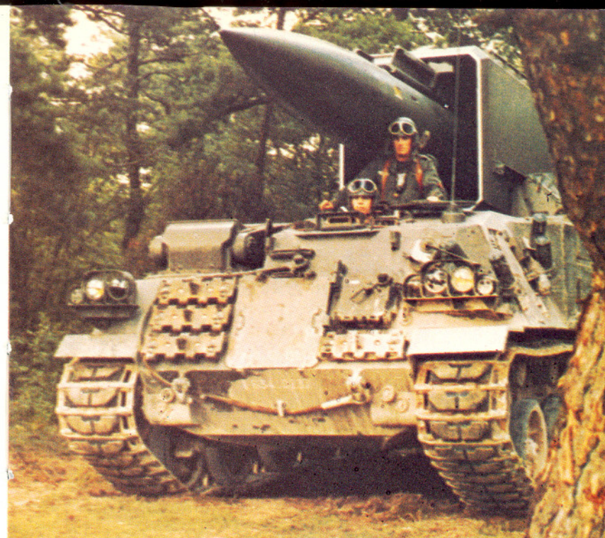
Fent: Az AMX-30 rugalmasságának egyik példája ez a Pluton harcászati atomrakéta szállítására és indítására használt harcocsi
