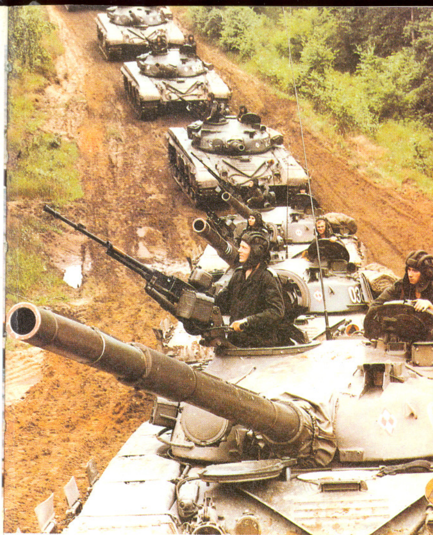
Fent: A T-72 harcokosi menetben; a Lengyel Szárazföldi Erő által beszerzett 400 db-ból hat (megfigyelhető a toronyra feltűnően elhelyezett rombusz alakú felségjelzés). Minden esetben a harcokosi parancsnoka kezeli az NSVT 12,7 mm-es géppuskát. A lengyel harcokosik PW-LWD aknamentesítő-rendszert szállítanak, amit a páncéltest tetejére, a vége felé helyeztek el
