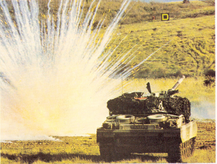
Fent: Vickers Mark 1 harckocsi a lőtéren. Ezen a modellen a 105 mm-es löveget a párhuzamosított, 12,7 mm-es, háromlövéses sorozatokat leadó célbelövő géppuskával irányozzák be
