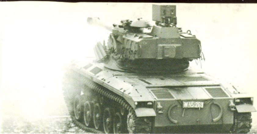
Fent: A Panzerjager K a 105 mm-es löveggel tüzel. Az üres hüvelyeket a torony hátulján lévő ajtón keresztül veti ki
