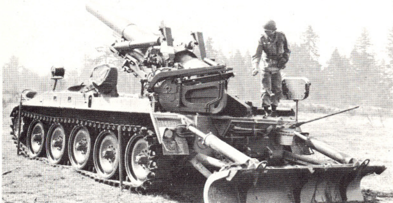
Fent: Az M110 hátulján lévő, hidraulikusan működtetett talptámaszt a tüzelés megkezdése előtt leengedik a szilárd kitémasztás érdekében
