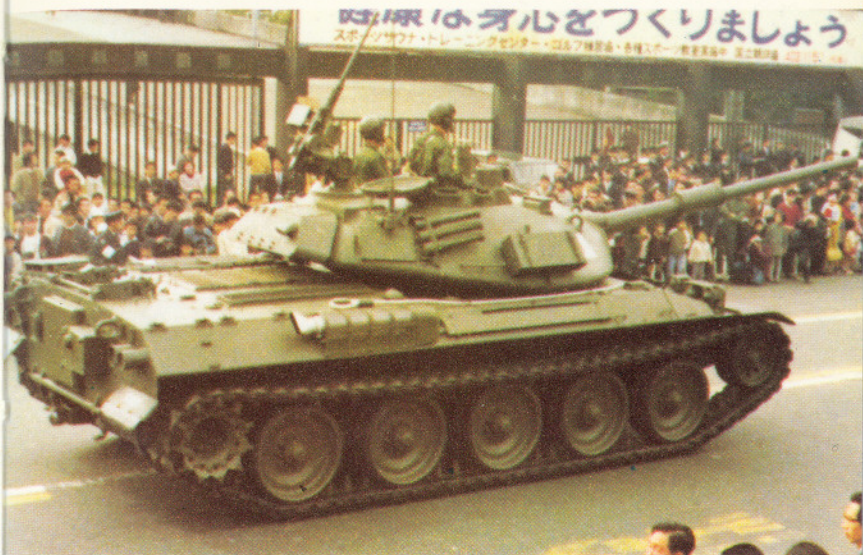
Fent: A 74 típusú harckocsi a Tokio melletti Mitsubishi Heavy Industries gyártotta, és – brit tervezésű, de licenc alapján Japánban gyártott – 105 mm L7 huzagolt csövű löveggel fegyverezték fel
